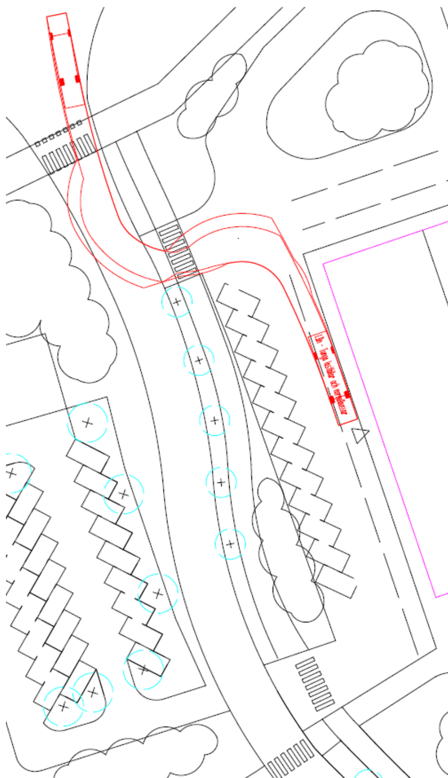
Figur 4-4 Körspår för typfordon Lbn (tung lastbil / normalbuss, 12m) som lämnar avlämningsytan väster om idrottssalen och kör tillbaka ut mot Ginnlögs väg.
