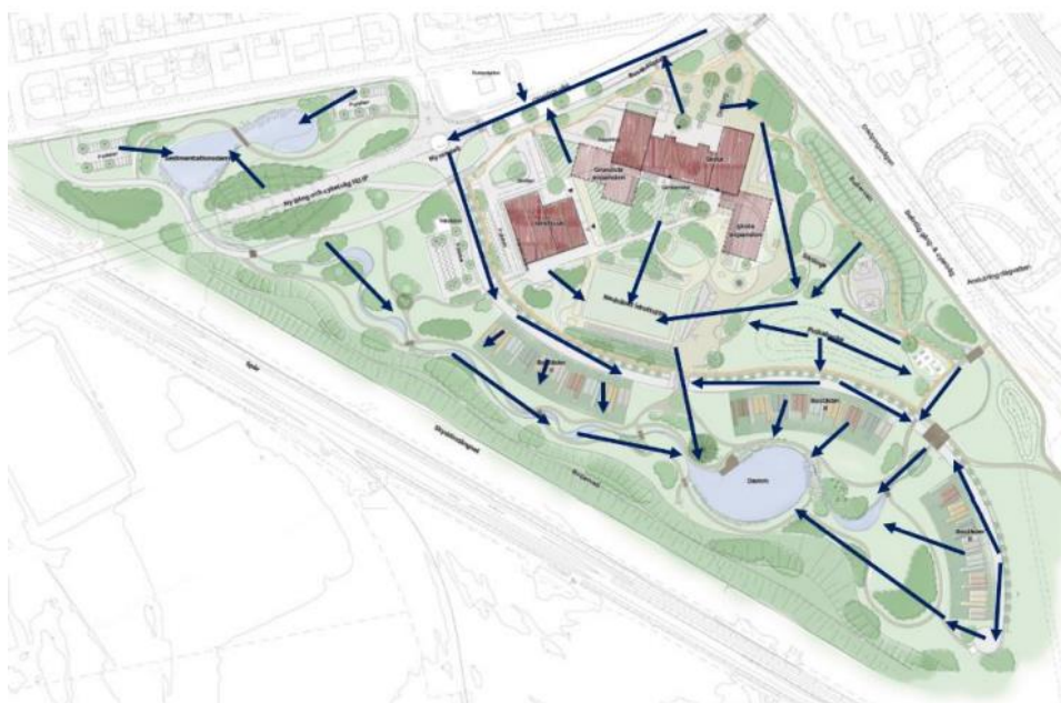
Övergripande princip för höjdsättning och ytliga avrinningsvägar. Pilarna pekar i nedåtgående riktning. Illustration av WRS
