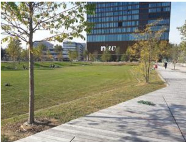
Exempel på nedsänkt grönyta som vid torrväder kan användas för bollek eller spontana aktiviteter men som vid nederbördstillfällena fungerar som utjämning och bidrar med rening. Foto: WRS.
