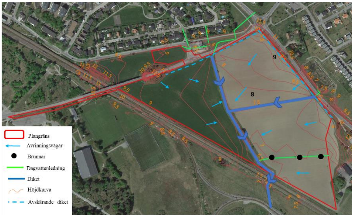
Figur 6. Befintlig dagvattenhantering inklusive flödesriktning i ledningar och på mark. Google street map (underliggande kartbild).
