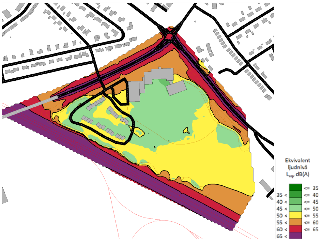
Bullerkarta, ekvivalent ljudnivå för väg och järnväg, på 1,5 meters höjd. Bild: Brekke &amp; Strand
