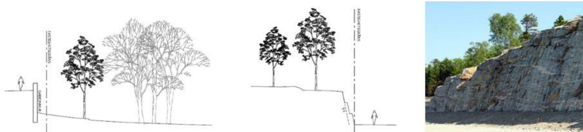
Exempel gabionmur mot fyllnad av kvartersmark och exempel på trappad bergskärning 5:1 med variation i släntfotens avstånd till asfaltytan. Bergskärningar ska utföras med skonsam sprängning.
