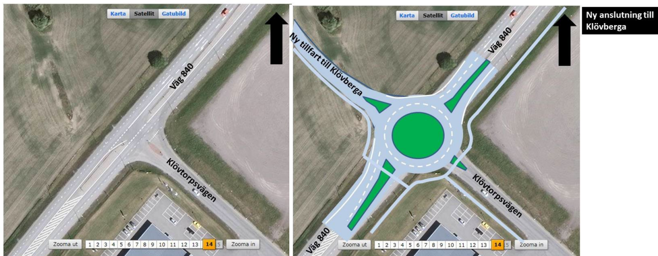
Figur 6.18 Till vänster bild över dagens 3-vägs korsning in till området mitt emot Klövberga, till höger bild över den tänkta cirkulationsplatsen med infart till Klövberga (Ramböll, 2021-02-15)
