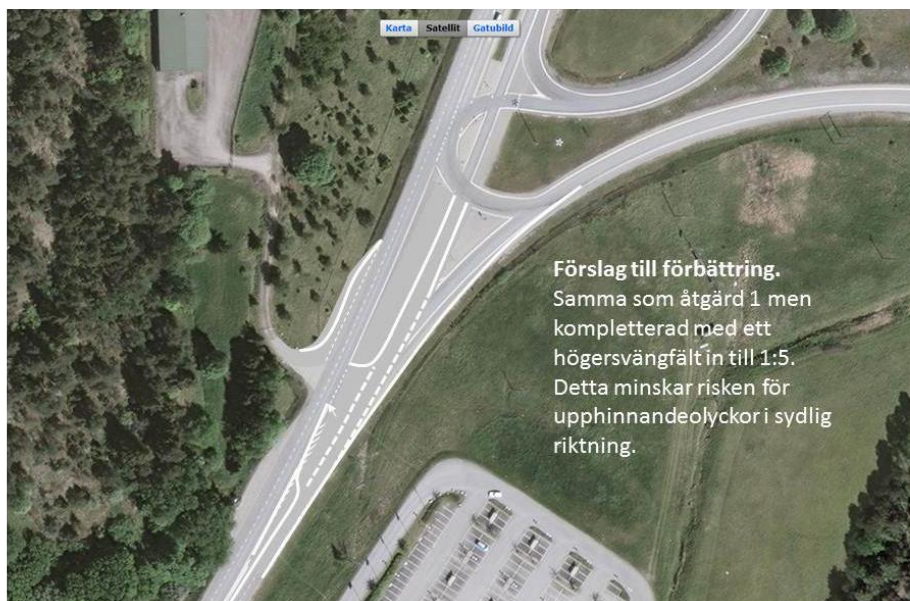
Figur 6 Förbättring av befintlig anslutning
