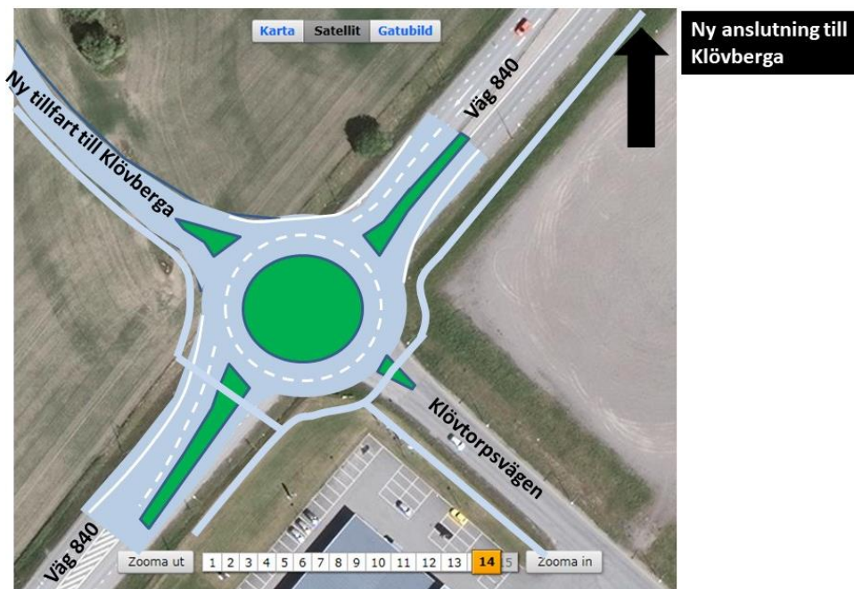
Figur 5 Förslag på utformning av cirkulationsplats i korsningen med Klövtorpsvägen
