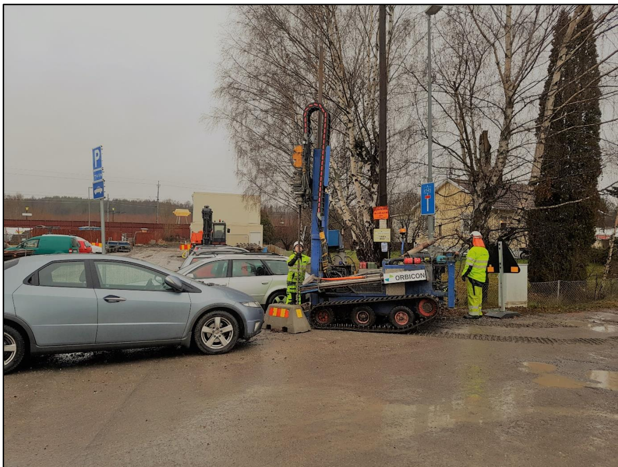
Figur 2. Skruvborrning vid provpunkt 17G102 i den sydöstra delen av undersökningsområdet.
