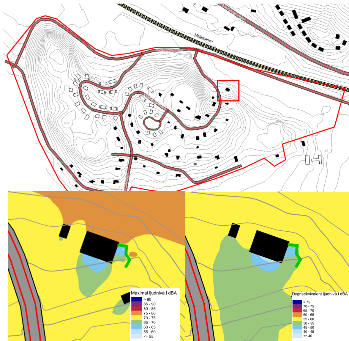
Figur 4. Förslag till lokal skärm vid befintligt bostadshus. Skärmen är 2,5 m hög och ca 12 m lång. Skärmförslaget innebär även att riktvärdet för maximal ljudnivå klaras på uteplatsen samt det dygnsekvivalenta kravet på uteplats i Avstegsfall A.
