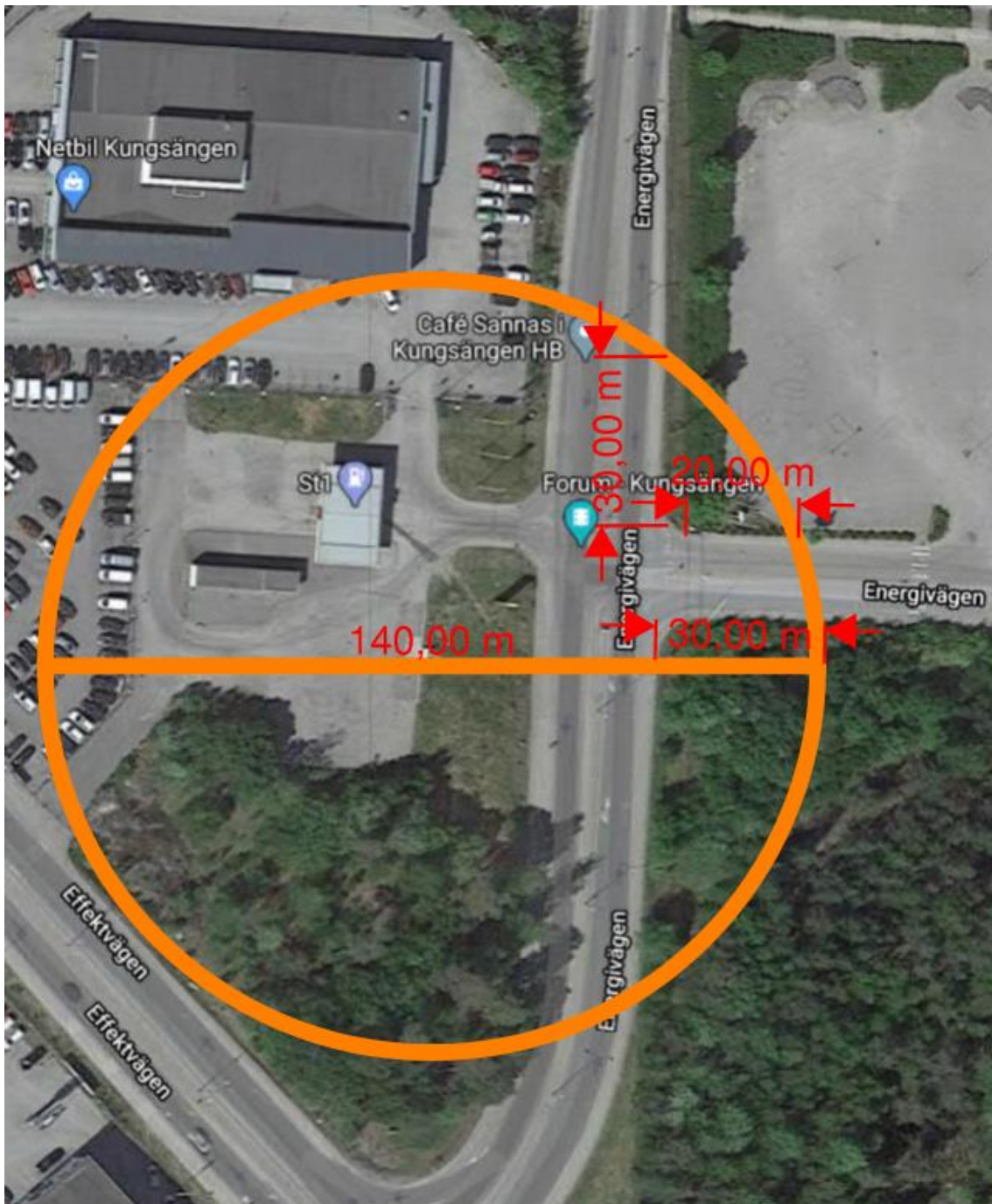
Figur 14 Område inom planområdet där åtgärd placering tilluftsöppning regleras på grund av närhet till drivmedelstation.
