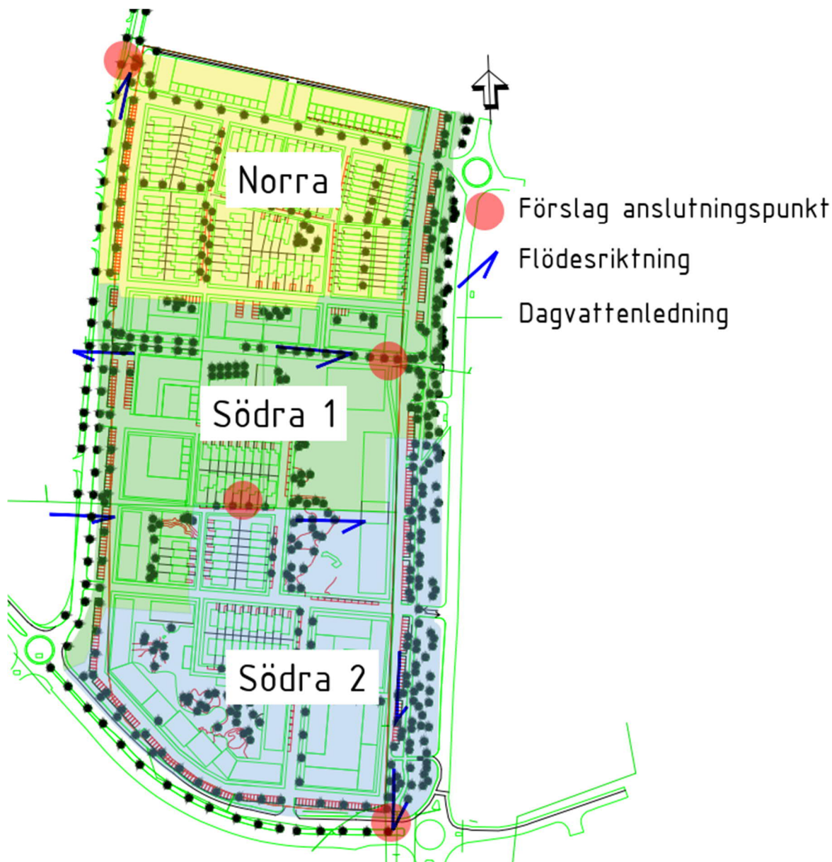
Figur 13. Tekniska avrinningsområden vid planerad situation. Avrinningsområde Södra 1 och 2 antas ha avledning mot samma dagvattennät söderut mot Görväln. Norra avrinningsområdet ansluter till ledningsnät norrut mot Skarven. Rosa streck visar plats för anslutning till kommunalt ledningsnät. (Strukturplan i bakgrunden erhållen av Arkitema Architects 2020-03-24).
