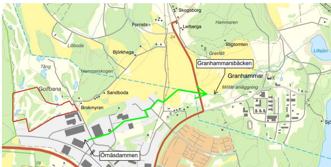
Figur 14. Teknisk avrinningsväg från Örnäsdammen till Granhammarsbäcken.
