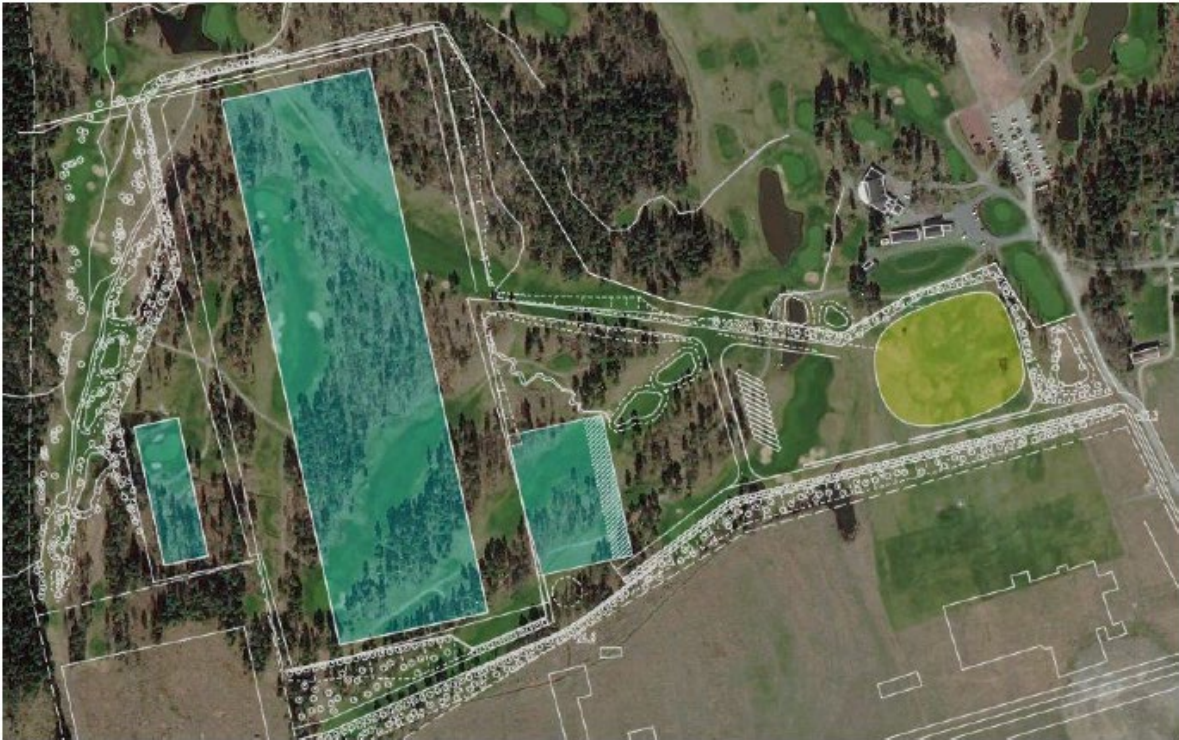
Planerad byggnation. Blå markering avser byggnader planerade inom fastmarksområde. Gul markering avser område där byggnad planeras delvis inom lerpartier.
