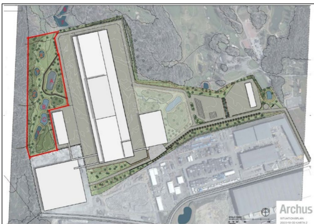
Figur 5-8 Översiktlig skiss av planområdet med reningsdammar för dagvatten (A) och sedimentationsdammar (B och C), befintliga salamanderdammar (1, 7, 8) samt nya salamanderdammar (X, Y och Z). Reningsdammen är avskild mot naturområdet med barriär. Bild från gestaltningsprogrammet (Archus Arkitekter, 2020).
