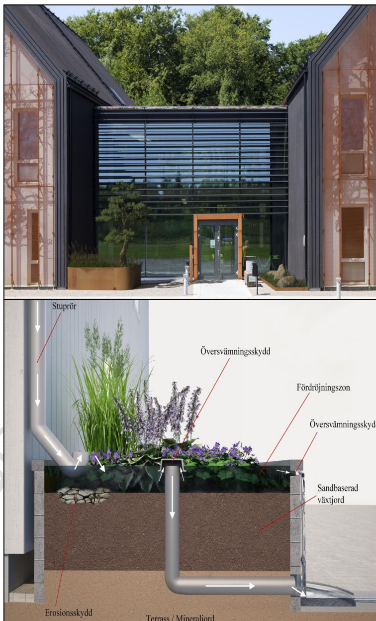
Figur 8. Övre bild: Illustration hur en raingarden skulle kunna se ut i praktiken. Nedre bild: Skiss av en tvärsnitt på ett växtmagasin/raingarden
