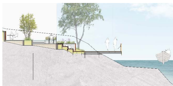
Bostadsgård - Strandpark med ramp, gradänger och gångbrygga
