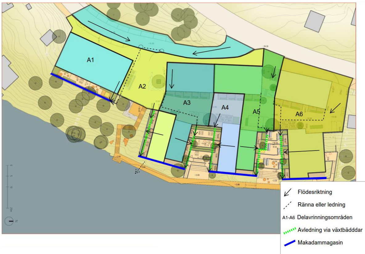
Figur 3. Principiell systemlösning för dagvattenhantering.
