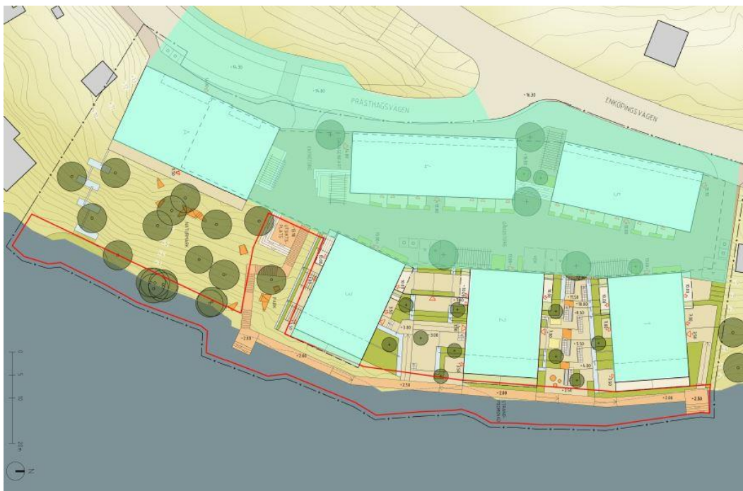
Figur 3. Arean av tak och angöring (0,5 ha) ligger till grund för flödesberäkningen. Övriga ytor bedöms avvattnas direkt till recipient.
