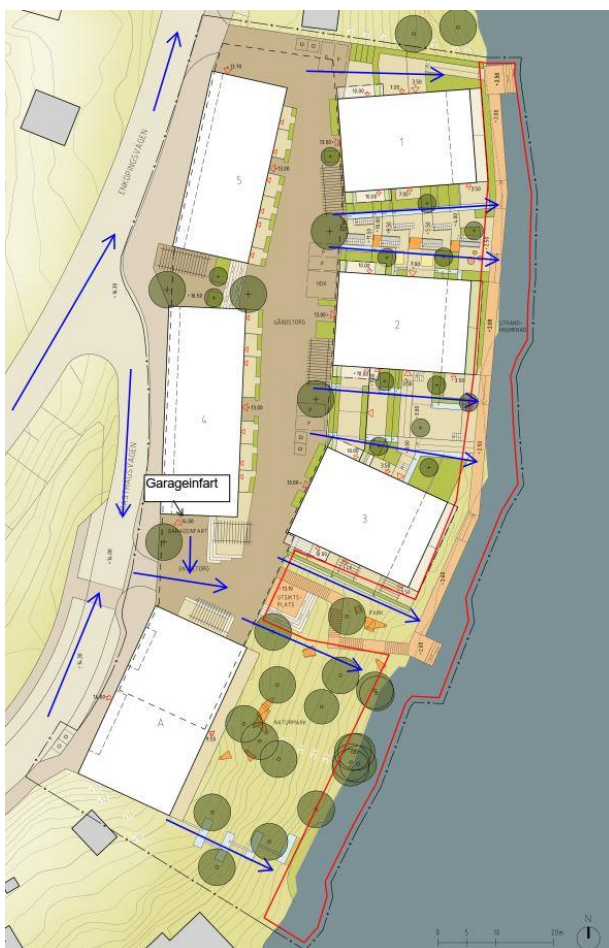
Figur 2. Planområdet efter exploatering. Blå pilar visar sekundära avrinningsvägar för ytlig avledning då ledningsnätet får fullt.
