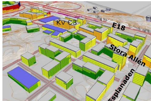
Figur 38: Karta för "Centrumkvarteren" som redovisar dygnsekvivalent ljudnivå från vägtrafik LAeq dB(A) frifältsvärde vid fasad med 2030 års trafik och med skärm mot E18. (Källa Akustikbyrån, 2017a)
