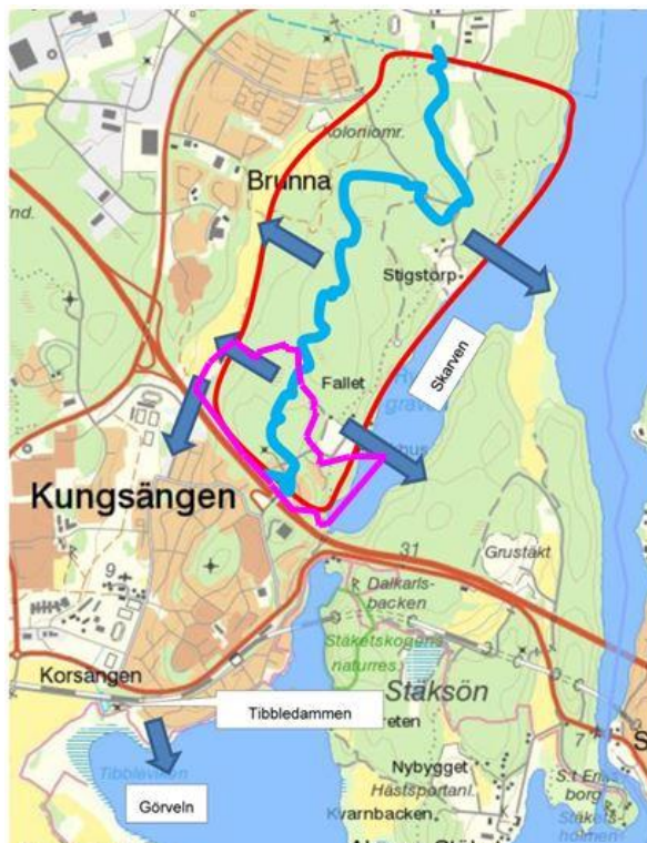
Figur 39: Karta över området med beskrivning av befintlig avrinning och närliggande recipienter. Blå linje= vattendelare, Blå pilar= befintligt avrinning (Källa Bjerking 2017a) Lila linje utgör intolkad detaljplanegräns för Entré Rankhus-DP1.
