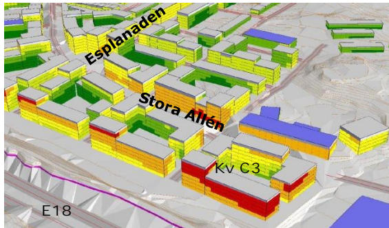
Figur 37: Karta för "Centrumkvarteren" som redovisar dygnsekvivalent ljudnivå från vägtrafik LAeq dB(A) frifältsvärde vid fasad med 2030 års trafik och med skärm mot E18. (Källa Akustikbyrån, 2017a)
