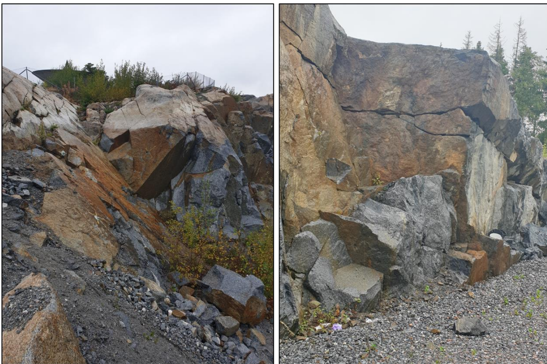
Figur 4-5. Oxiderade sprickytor i norra delen av detaljplaneområdet.
