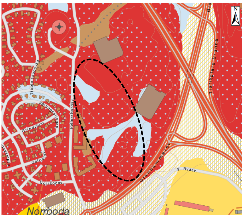
Figur 3. Jordartskarta (sgu.se). Planområdets ungefärliga läge markerat med svart streckad linje. Berg visas med röd färg, morän med blå färg.
