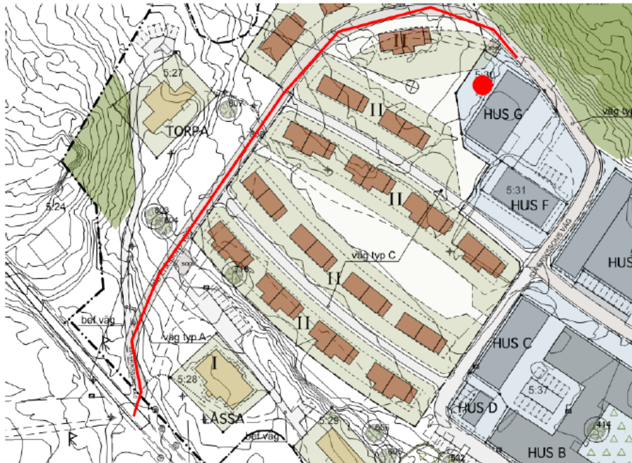
Figur 6.10. Förväntad körväg för transport av gasol till mikrobryggeri i hus G. Gasoltank är markerad med röd cirkel (Prevecon, 2019).
