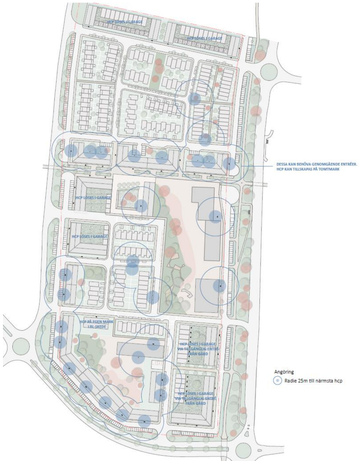
Angöringsmöjligheter parkering för rörelsehindrade. Bild: Arkitema
