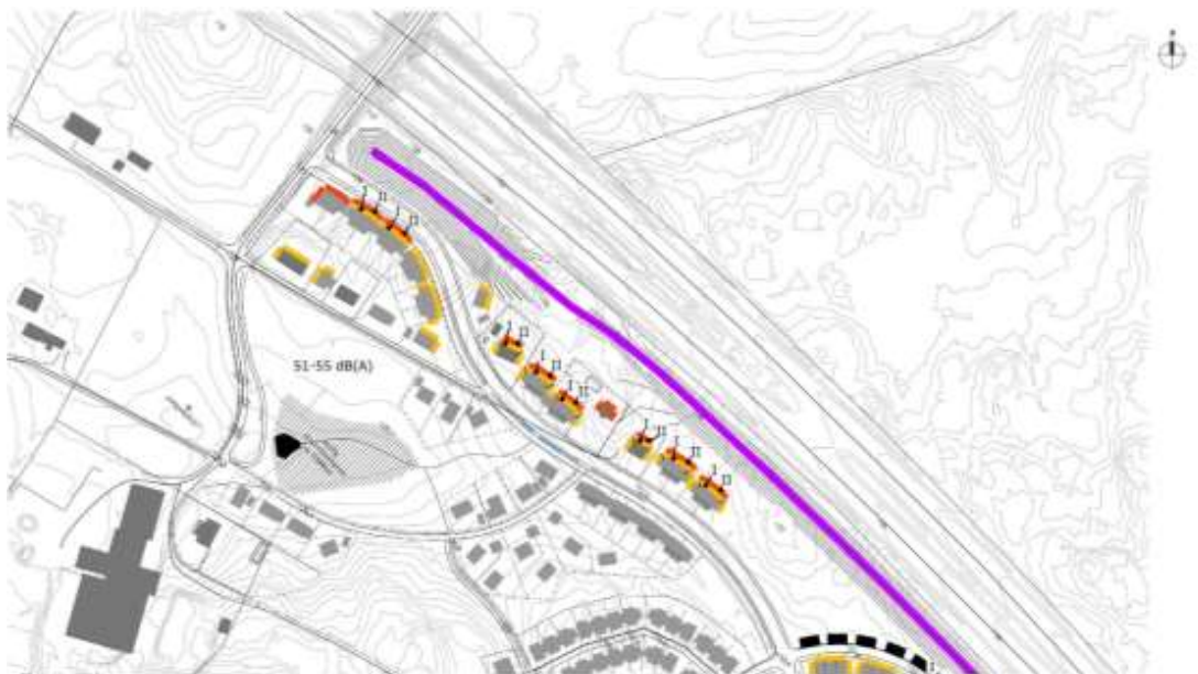
Figur 46 Trafikbuller, ekvivalentnivåer ljudnivå vid fasad. Mörkröd, 66-70 dB(A). Röd, 61-65 dB(A). Orange, 56-60 dB(A). Fasader utan färgmarkering påverkas inte av buller som överstiger en nivå om 55 dB(A).
